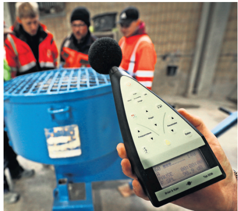
Lärmmessung auf der Baustelle Foto: Potente
